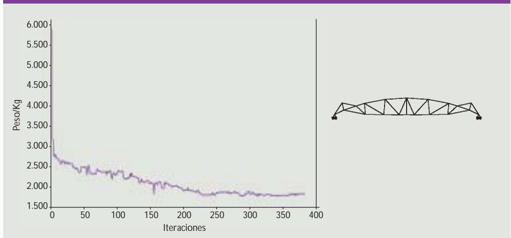
Figura 10. Peso óptimo de la estructura 1822 kg. Reducción de peso 28.8%
